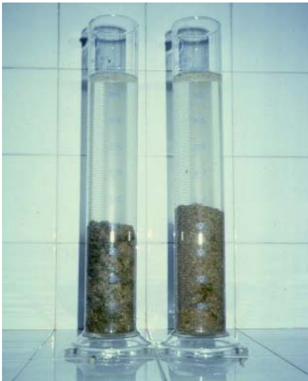
Figure 12 – Délitement terminé dans les deux éprouvettes
