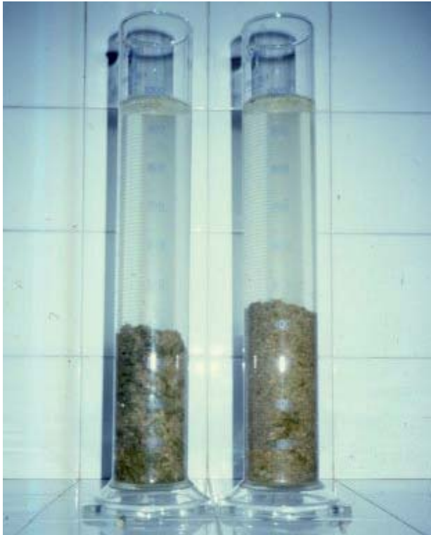
Figure 11 – Délitement terminé dans l'éprouvette de droite
